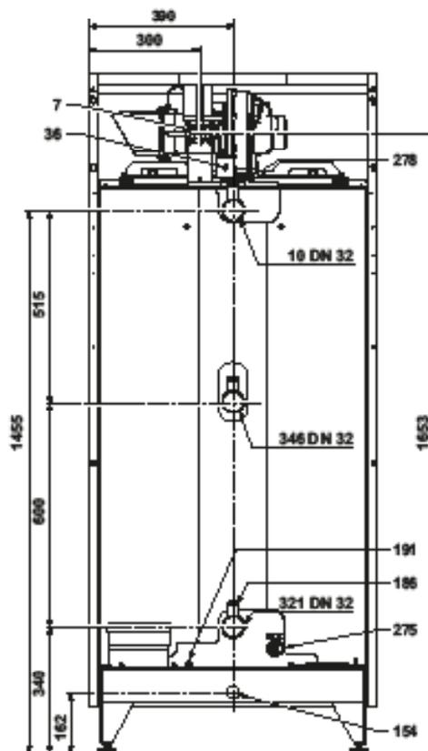
Fig. 77 - Vue arrière modèle H 228
