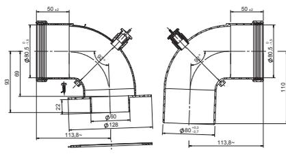
Adaptateur tuyaux séparés Ø 80/80 mm avec point d'essai
